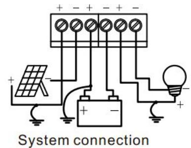
图 2 控制器的系统连接
